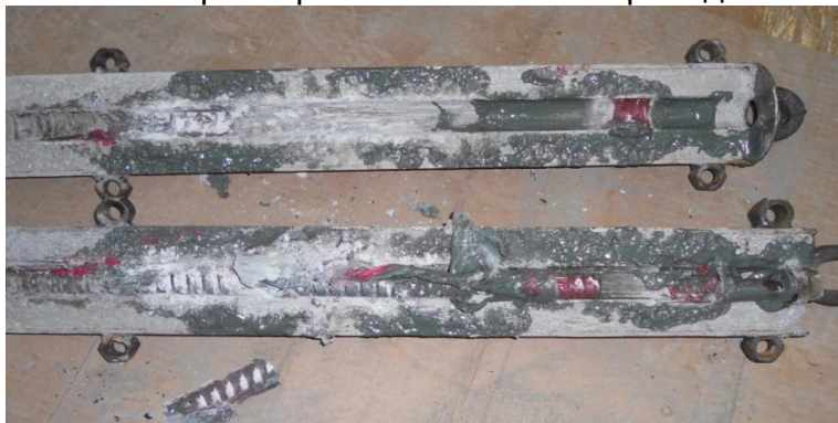
Рисунок 1 – Искусственная скважина с анкером после испытаний
